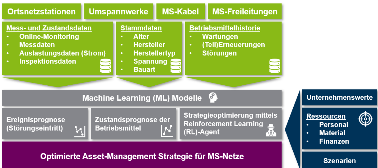
Abbildung 1: Zielbild zur Optimierung der Asset Management Strategien für Betriebsmittel der Mittelspannungsnetze gestützt durch Machine Learning Modelle
